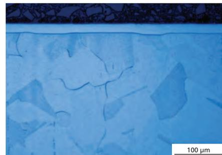
Zone S générée par HARD-INOX®-S (1.4404). La zone superficielle est devenue dure sans compromettre la résistance à la corrosion.
