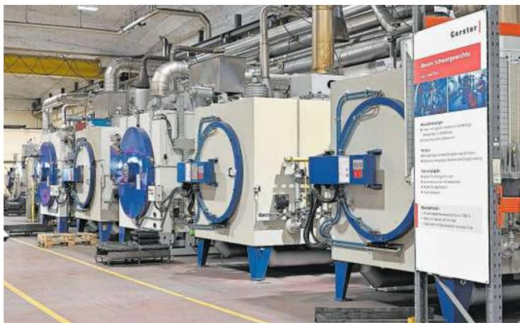
In den Vakuumöfen werden beispielsweise Operationsinstrumente gehärtet.
