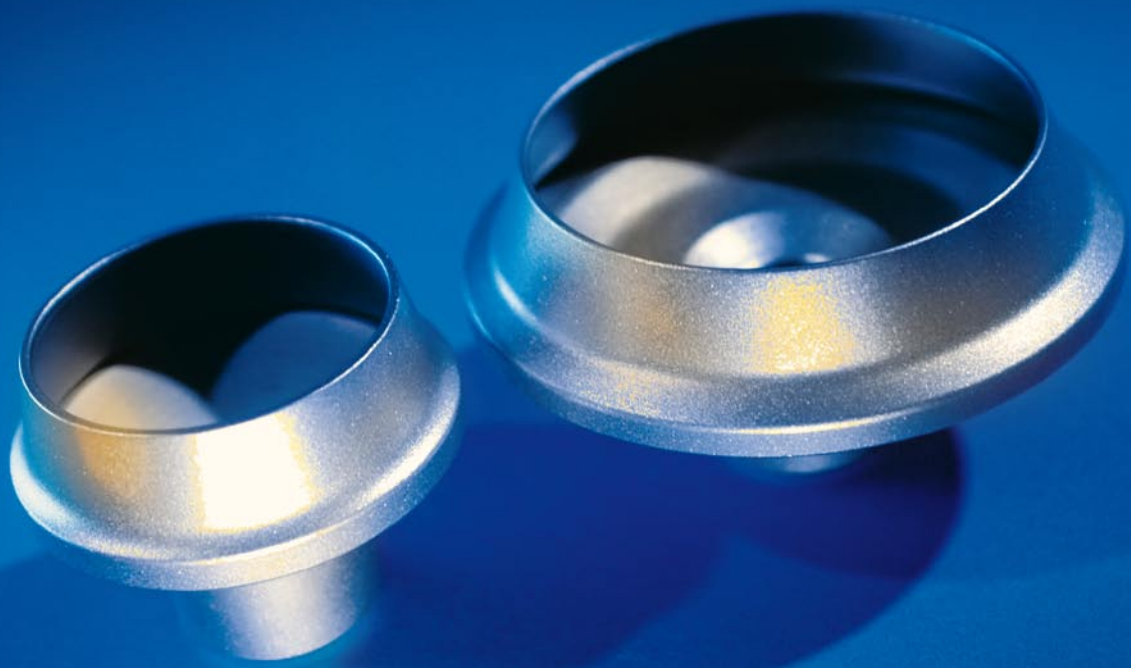
Industrie textile: Têtes de rotor pour production du fil. Acier d'amélioration, boruré partiellement, puis trempé-revenu et revêtement.
